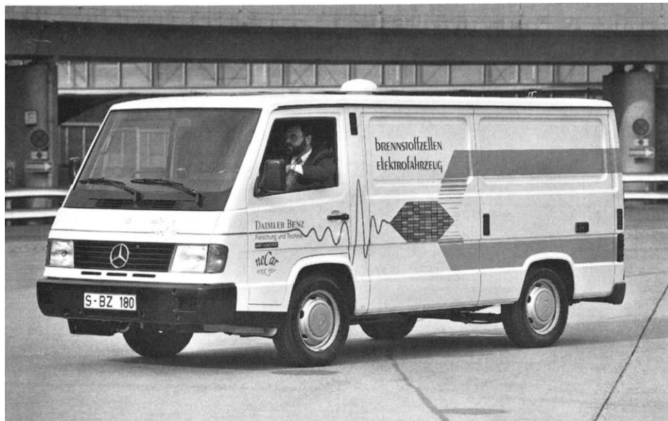
Fig. 7. Daimler-Benz fuel cell powered Mercedes MB 180 van.
